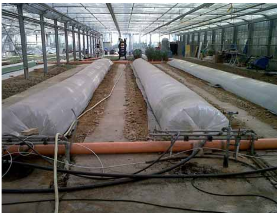
L'impianto che utilizza le alghe per pulire l'acqua da azoti e fosfati, dalle stesse alghe è possibile generare olio al fine di produrre energia pulita.
